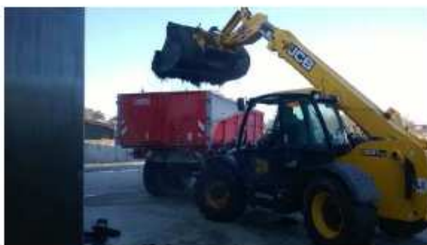
Déchargement du digestat
